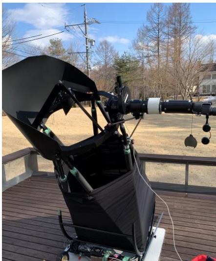
④ NV の対物レンズをはずし望遠鏡に直焦点で接続 (Prime Focal といいます。)
