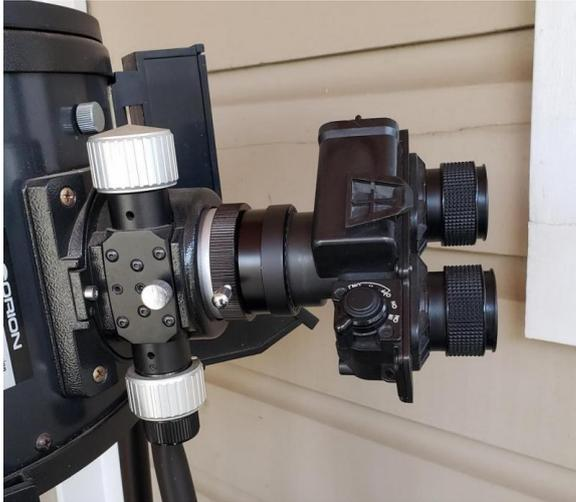
PVS-7 Prime Focal 直焦点での接続
